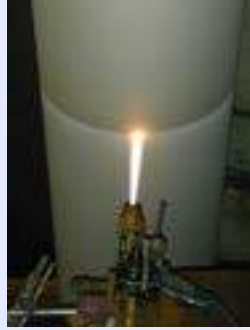
ロール面摩耗への補修
