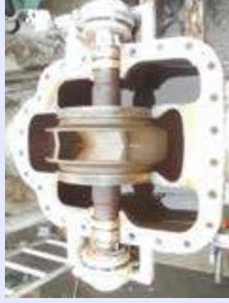
遠心渦巻きポンプ(内部)
