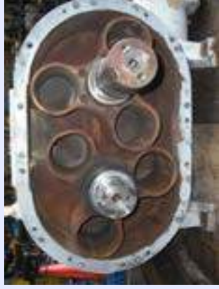
ルーツブロワ(内部)
