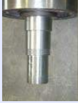
ジャーナル入替補修
