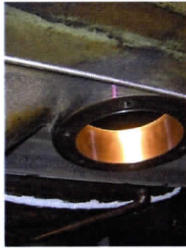
ボーリング加工 完了
