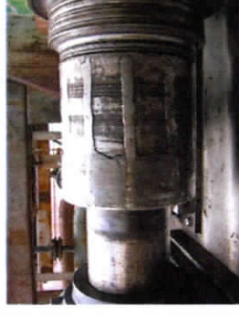
ジャーナル補修前
