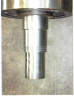
ジャーナル入替補修
