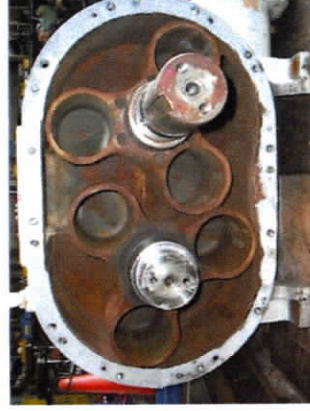
ルーツブロワ(内部)
